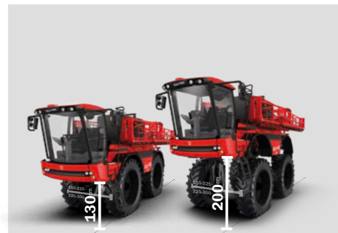
Гидравлический изменяемый клиренс от 130 до 200 см
