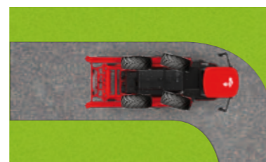
Три типа рулевого управления; Рулевое управление передними колесами (идеально для движения по дороге)...
