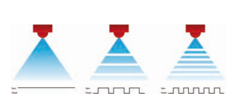
StrictSprayPlus определяет скорость и необходимый расход для каждого распылителя
