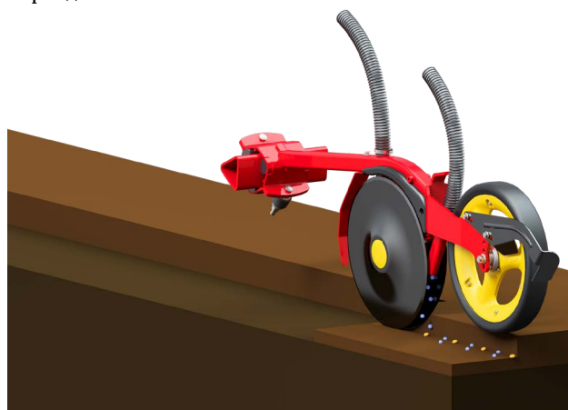
В версии InLine удобрение подается вместе с семенами через отдельное выпускное отверстие в высеивающем сошнике.
